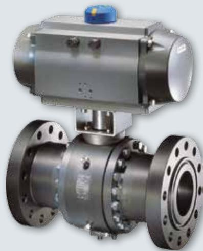
**SAMSON VETEC** – La válvula Maxifluss de VETEC reúne en una sola válvula las ventajas de las válvulas tipo globo, mariposa y bola. Su construcción universal permite su uso tanto en aplicaciones normales como críticas. Con su diseño excéntrico, el obturador rotatorio entra en contacto con el asiento solo en la posición de cierre, lo que brinda un control exacto y un amplio rango de regulación.
